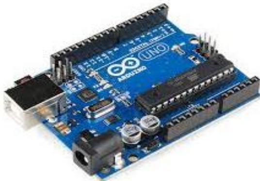
Figure 3: Arduino UNO Rev3- ATmega328
