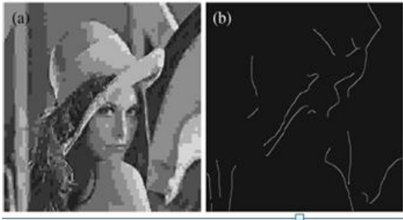
Fig 7 Edge map of Lena by Canny Edge Detection
